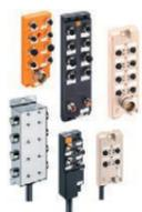
无源 I/O 分线盒有多种配置,几乎可以满足每个设备上的应用需求。这些分线盒提供 4、6、10 和 12 口设计, M8 或 M12 连接,单通道或双通道,线缆出线型或接口型。所有的版本均可带有或不带 LED 功能指示灯。
