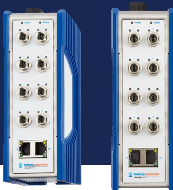
Le commutateur administrable BEETLE Lite de Lumberg Automation accompagne la transition vers des réseaux d'avenir construits avec la technologie de l'Ethernet à paire unique (SPE), prenant en charge une connectivité transparente capteur-cloud.
