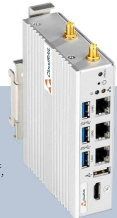
Beldens **CloudRail** Software nimmt Daten von älteren und modernen Geräten in industriellen Umgebungen auf, verarbeitet sie lokal vor und sendet sie – gebrauchsfertig – zur weiteren Analyse und Verarbeitung an eine beliebige Cloud.
